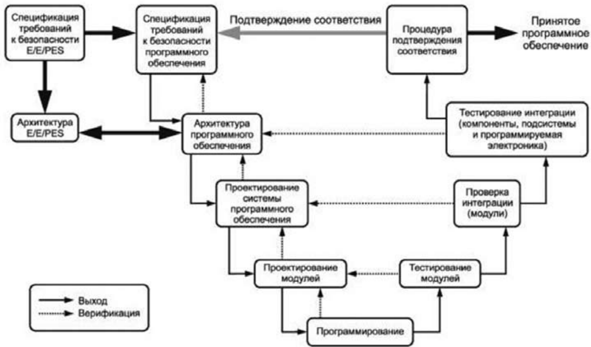
Рис. 4. V-модель, которая используется в стандарте IEC 61508
